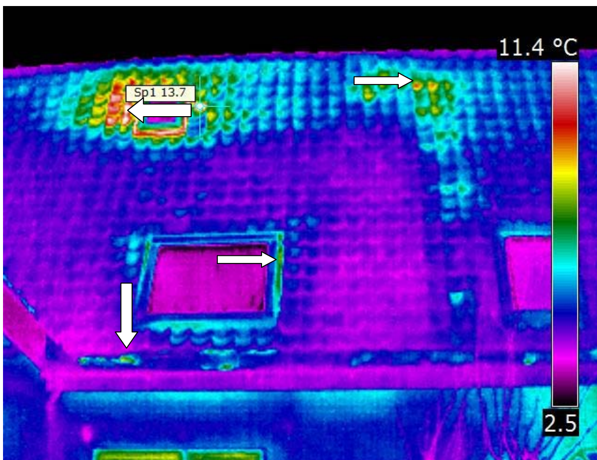
De pijlen in de afbeelding geven de meest grote lekkages weer
